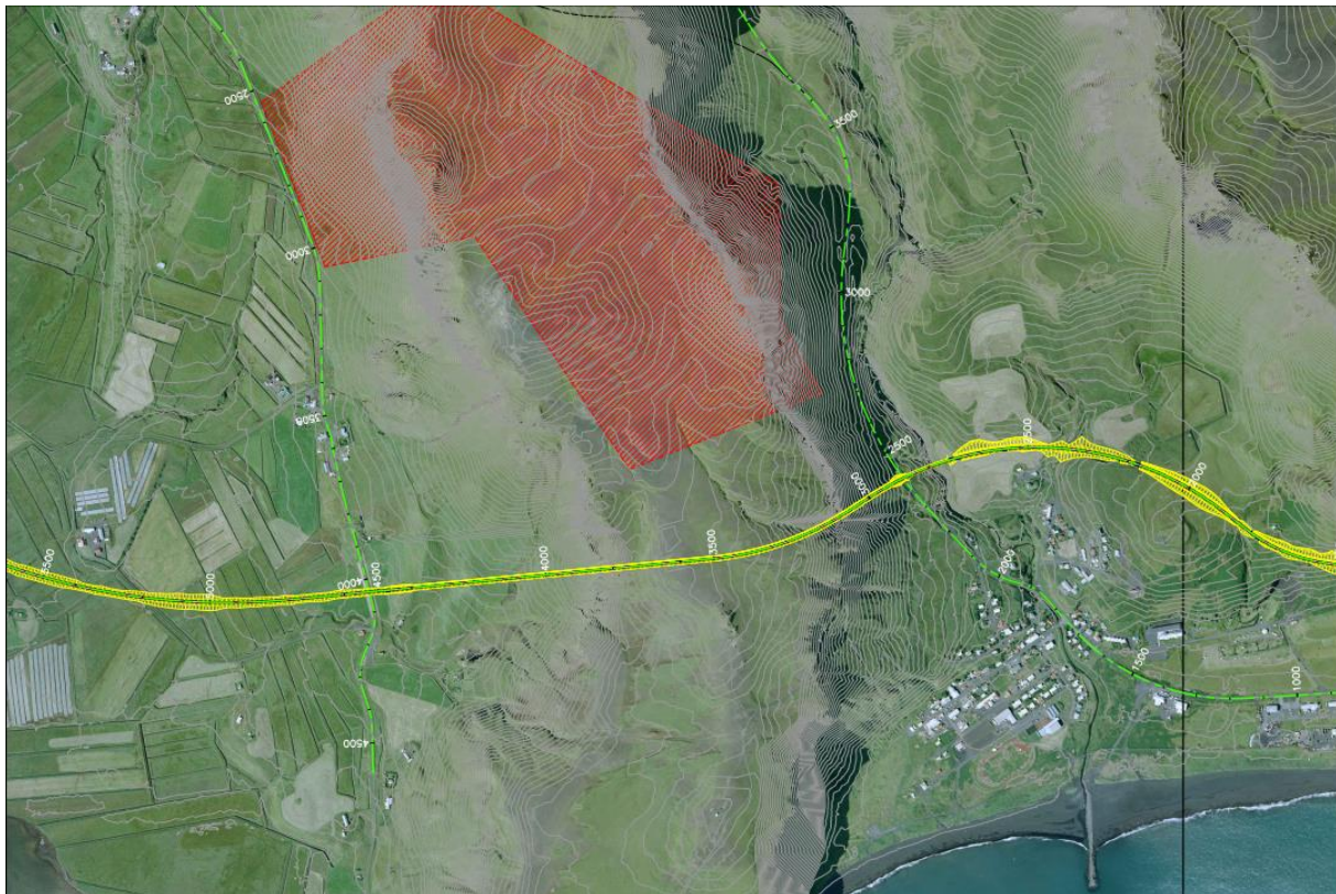
Mynd 6 – Farið er frá ósnum, á milli Reynisholts og Þórisholts að Reynisfjalli norðan við Reyniskirkju, undir Reynisfjall og norðan við Norður Vík. Jarðgöng eru um 1,5 km löng.
